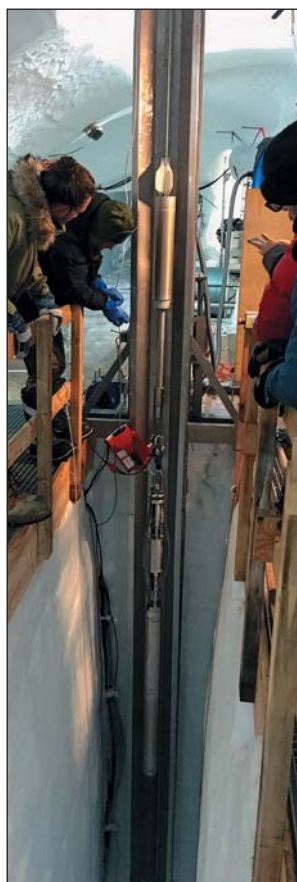
Ловильные операции в скважине EGRIP: слева — крюк, прикрепленный к распорному устройству; справа — аварийный снаряд, поднятый из скважины.
