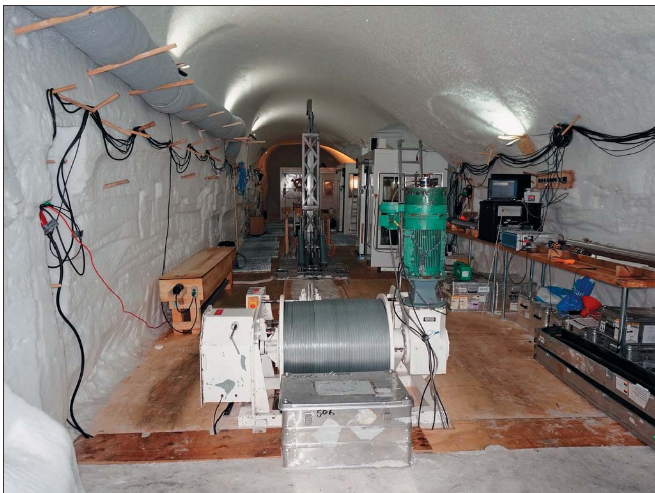
Буровая траншея EGRIP, июль 2017 г. На переднем плане буровая лебедка с электромеханическим кабелем. Также показаны буровая мачта (в центре) и кабина оператора бурения (справа).
