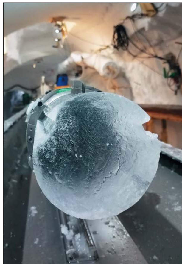
Ледяной керн, высовывающийся из снаряда после его подъема. На поверхности льда кернорвателями прорезаны две продольные канавки.
