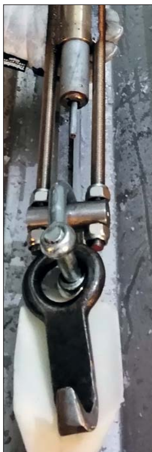
Ловильные операции в скважине EGRIP: слева — крюк, прикрепленный к распорному устройству; справа — аварийный снаряд, поднятый из скважины.
